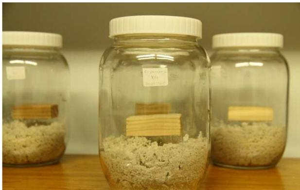
Figura 2.1 – Início de ensaio segundo a norma EN 117:2005, utilizando o cerne de madeira de Criptoméria (*Cryptomeria japonica*)
