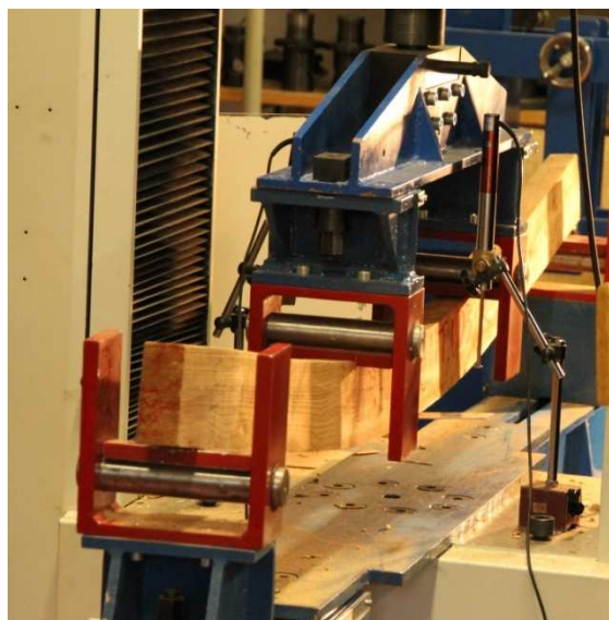
Figura 3.10 – Proвете de S. Miguel durante ensaio mecânico
