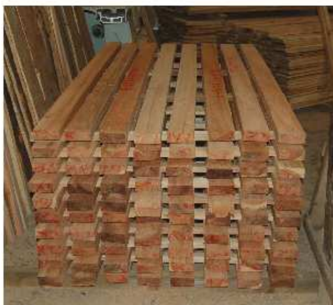
Figura 5. 80 provetes de dimensões 40mm x 100mm x 2000mm.
