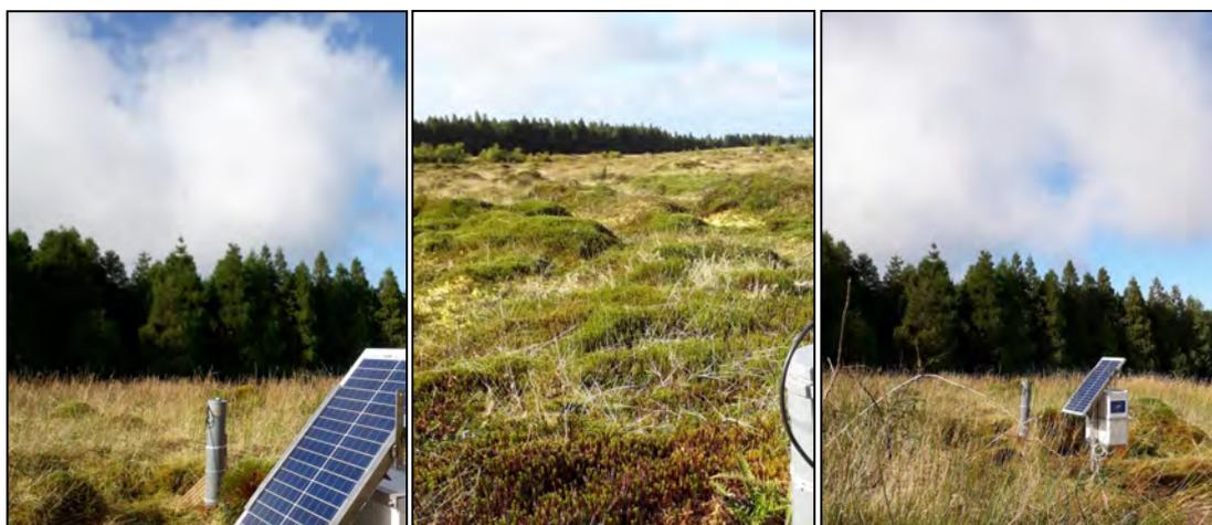
Figura 7. Sensores instalados no planalto dos Graminhais: Esta o com alimenta o solar (esq.); sensor de n vel de  gua, posicionado no interior de tubo de pvc (centro); pluvi metro em primeiro plano (esq.).
