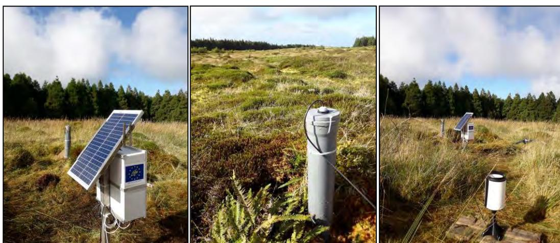
**Figura 7.** Sensores instalados no planalto dos Graminhais: Estação com alimentação solar (esq.); sensor de nível de água, posicionado no interior de tubo de pvc (centro); pluviómetro em primeiro plano (esq.).
